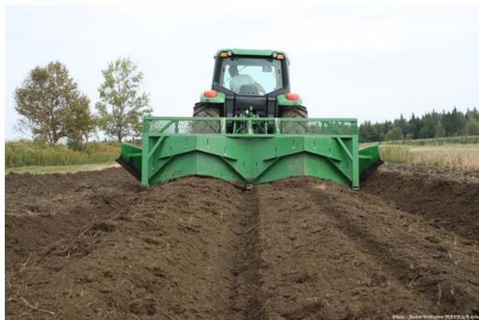
Photo 2. Formation des billons par le prototype
